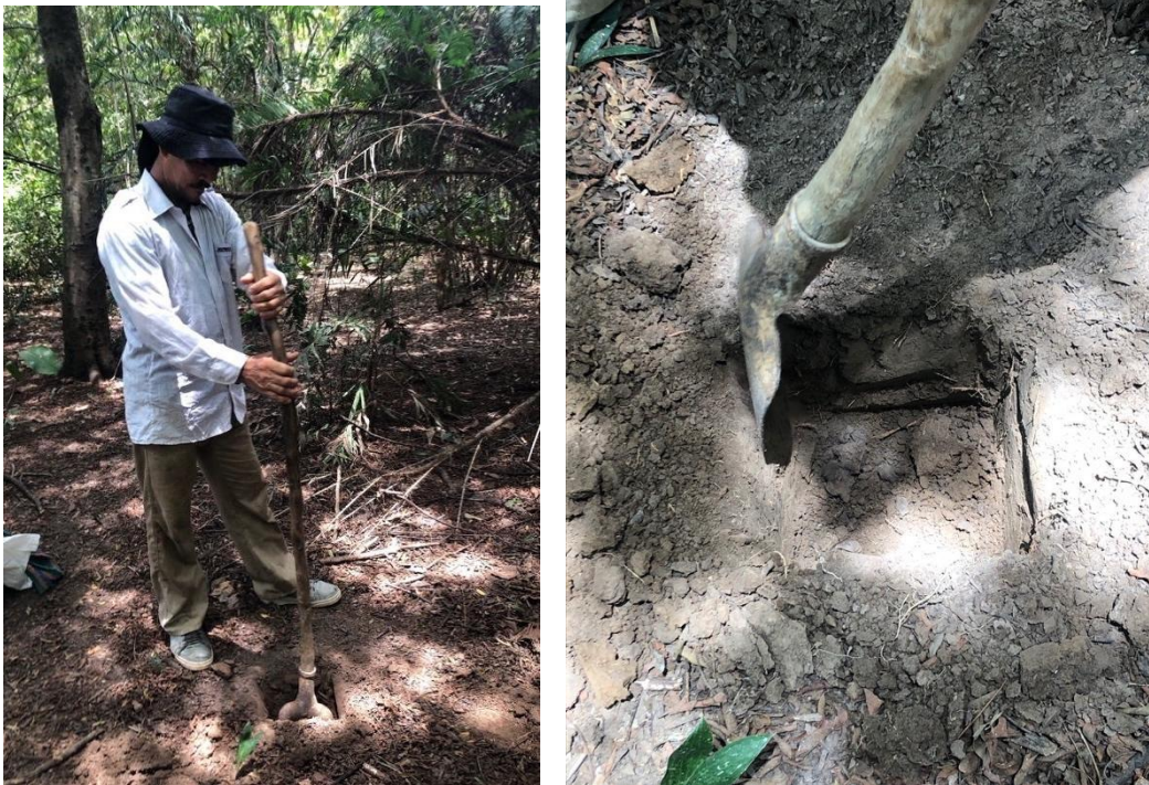
Figura 19. Toma de muestras para la caracterización preliminar de suelo. Se observa cómo se hace el hoyo de 20 a 30 cm de profundidad y cómo se toma la tierra de uno de los perfiles verticales. En cada sitio de muestreo se tomaron entre 3 a 5 submuestras para hacer una muestra compuesta.
