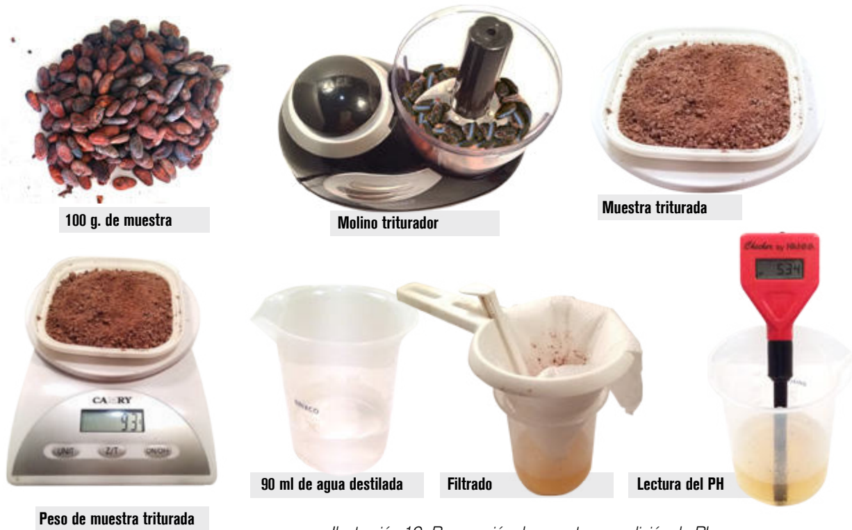
Ilustración 19. Preparación de muestra y medición de Ph.
