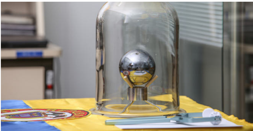
Ilustración 1. Esfera de Silicio. Pesas clase F1. Trazabilidad del Laboratorio de masa del INM
