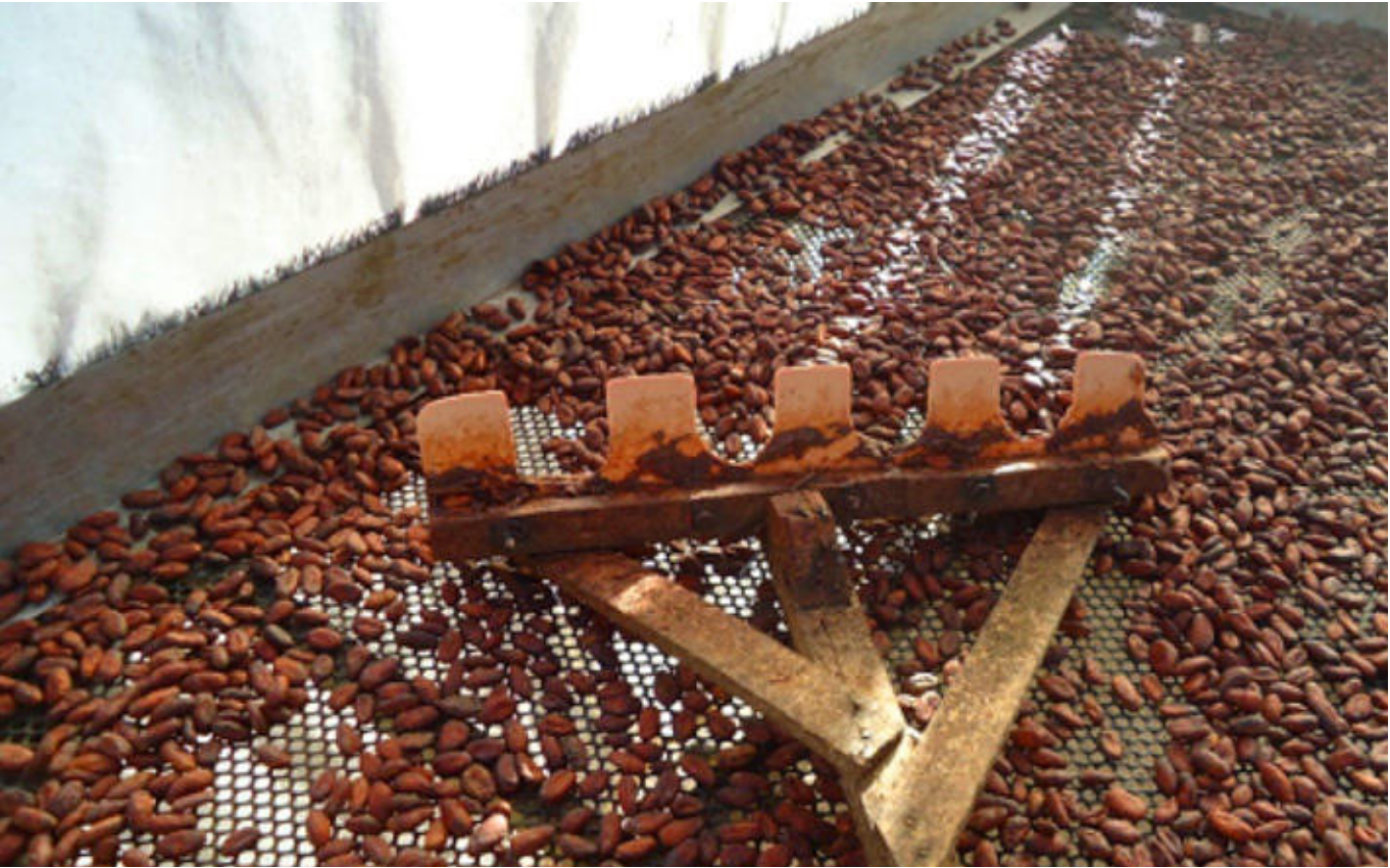
Ilustración 52. Superficie de secado en malla plástica y rastrillo con dientes plásticos.
